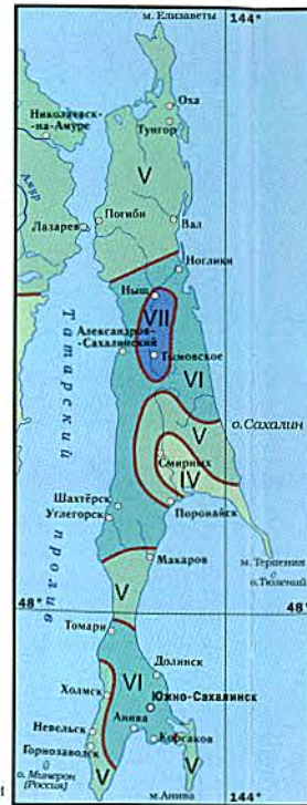
КАРТА 1а. РАЙОНИРОВАНИЕ ТЕРРИТОРИИ ОСТРОВА САХАЛИН ПО РАСЧЕТНОМУ ЗНАЧЕНИЮ ВЕСА СНЕГОВОГО ПОКРОВА
